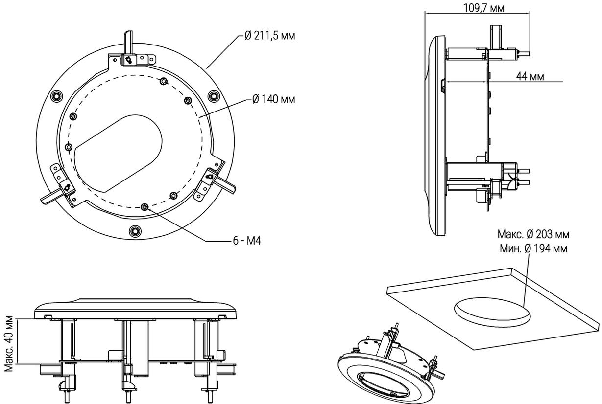
Рисунок 4.1 – Габаритные размеры
