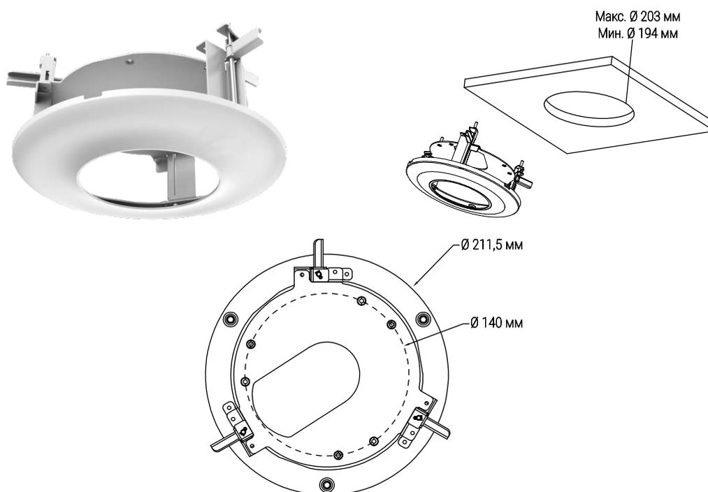
Рисунок 4.2 – Габаритные размеры. Кронштейн BR-112
