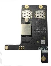
Плата GPRS-связи DS-PM2-G является печатной платой, на которой смонтирован модуль GPRS-связи и другие элементы коммутации и управления для охранной панели AX Hybrid Pro.
