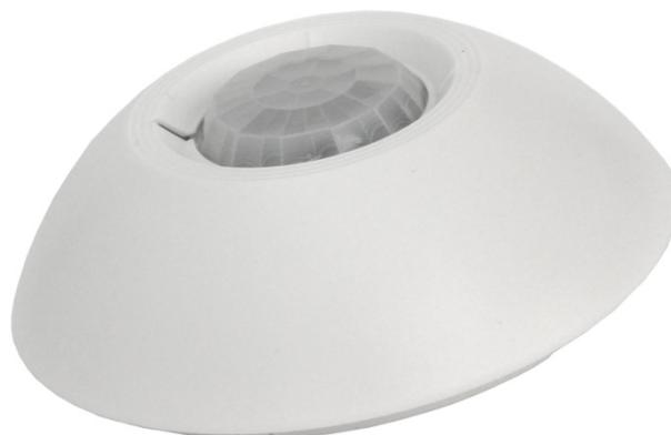
Пассивный инфракрасный извещатель ST-AD300P предназначен для обнаружения движения и защиты объекта от несанкционированного проникновения. Совместное использование сдвоенного пироэлемента, цифровой обработки сигналов и термокомпенсации позволяет минимизировать количество ложных срабатываний. Кроме того, извещатель имеет компактный корпус, выполненный из негорючего пластика.
