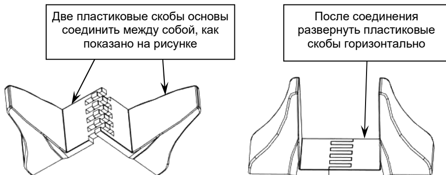
Рисунок 3 – Сборка пластиковых основ для вертикальной установки изделия
